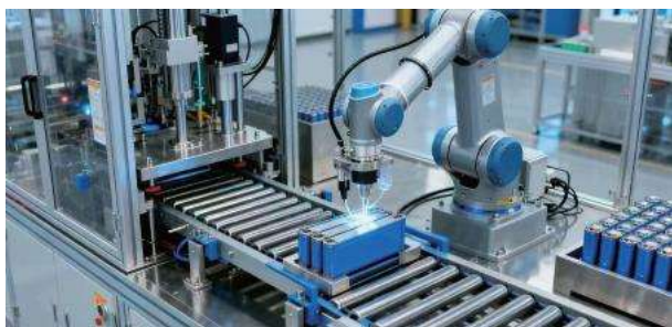
锂电 — 电芯注液上下料搬运工位
